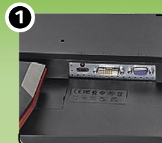
Монитор оснащен тремя видеовходами: DVI, VGA и HDMI
