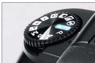
Колесо настроек имеет достаточно неудобное размещение и утоплено в корпус. Крутить его можно лишь одним пальцем
