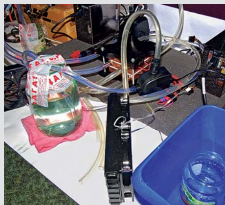
Первый пуск ТЭМ-чиллера в полевых условиях
