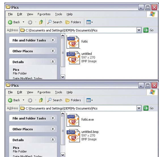
Вверху: так выглядят замаскированный и обычный файлы при отключенном отображении расширений Внизу: они же, но уже с отображаемым расширением
