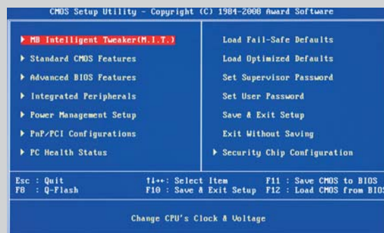
Основное меню BIOS одной из материнских плат производства Gigabyte. Внизу приведены краткие подсказки – описания назначения отдельных клавиш
