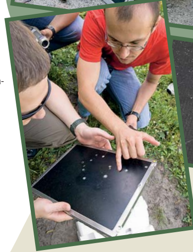
Стрельба по обычной матрице из любого типа спортивного оружия приводит к печальным последствиям. Отверстия отличаются глубиной, но по губительности одинаковы – такую панель лучше сразу выбросить.
