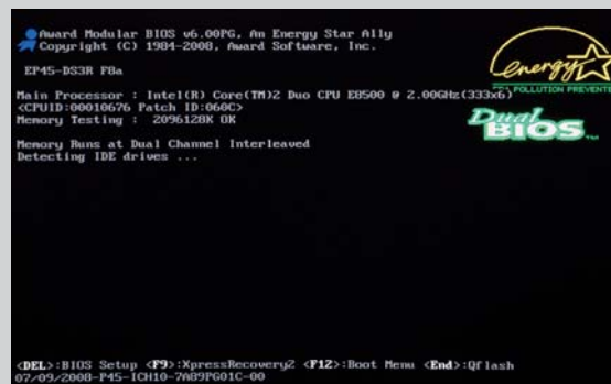
Система проходит процедуру инициализации (POST). Чтобы попасть в BIOS, в данный момент нужно нажать клавишу Del (об этом гласит надпись в нижней левой части экрана)
