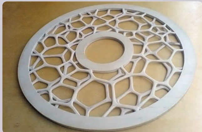
» Решетка-паутина на боковую панель корпуса. Работы по вырезанию ячеек и шлифовке дерева успешно завершены
