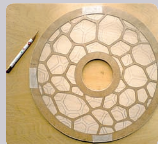
» Разметка заготовки под решетку с помощью шаблона
