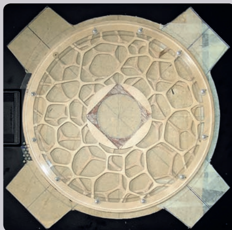
» Предварительная примерка корпусного окна из оргстекла, дополненного решеткой-паутиной
