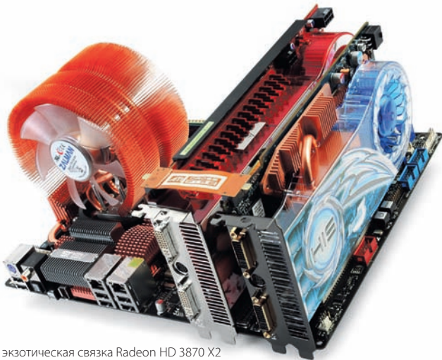
Даже экзотическая связка Radeon HD 3870 X2 и HD 3870 работает в режиме CrossFire
