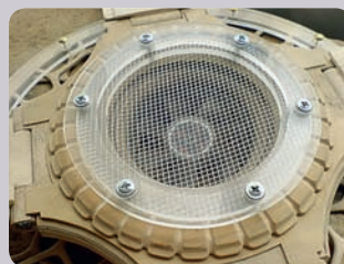
» В специальной нише боковой панели установлен вентилятор
