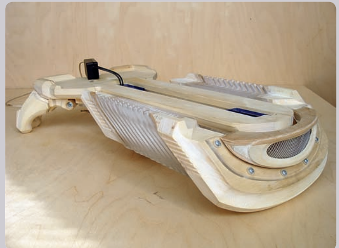
» Основание-подставка проекта Phantom в сборе. Между продольными рейками спрятана лампа подсветки
