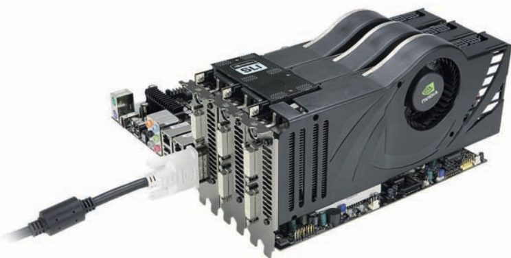
Для согласования работы трех видеокарт используется специальный мостик
