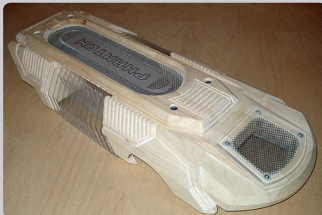
» Накладка на верхнюю панель корпуса. Внутри установлена дополнительная лампа подсветки, с шасси перемещены кнопки Power и Reset
