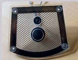
» Кнопки Power и Reset пришлось перенести на панель из оргстекла
