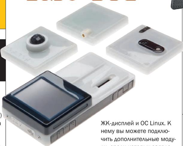
Компания Bug Labs предлагает интересную концепцию, согласно которой вы самостоятельно собираете желаемый портативный гаджет. Основной модуль BUGbase включает в себя довольно мощный процессор ARM1136JF-S, 128 МБ RAM, USB, Ethernet, модуль Wi-Fi, аккумулятор,
