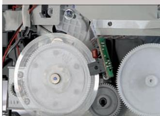
» Распределение крутящего момента основного привода осуществляется с помощью шестереночной передачи
