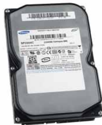
Samsung SP2504C: 250-гигабайтовый винчестер с интерфейсом SATA II
