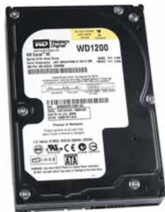
Western Digital WD1200JS: модель с интерфейсом SATA II емкостью 120 GB
