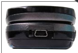
Разъем Mini-USB расположен на нижней грани корпуса MPx200
