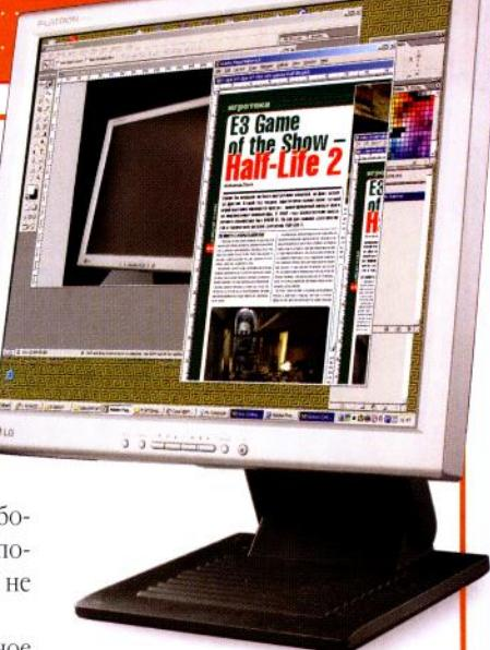
Снижение цены на L1811S достигнуто в какой-то мере за счет упрощения конструкции. В мониторе нет входа DVI, что обирается необходимостью иметь хорошую видеокарту с качественным 2D-изображением. Подставка у L1811S – простейшая, позволяющая регулировать только наклон панели.
