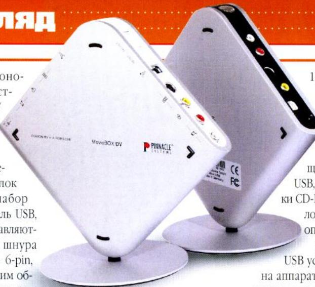
MovieBox USB поддерживает аппаратную компрессию видео в формат MPEG-2 (720 × 576, 480 × 576, PAL/SECAM, 25 fps) с потоком данных 1–12 Mbps для USB 2.0 или 1–6 Mbps для USB 1.x; а также в стандарт MPEG-1 (352 × 288, PAL/SECAM, 25 fps) со скоростью передачи информации
