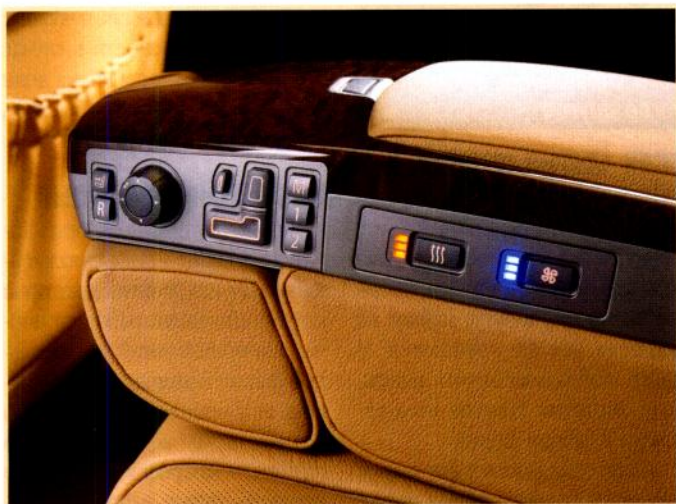
Даже кресло имеет память: с помощью кнопок 1 и 2 можно «запомнить» параметры формы и положения автомобильного сиденья
