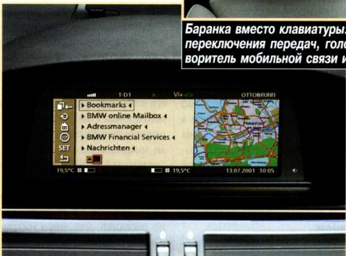
Броузер, интегрированный в бортовой компьютер, позволяет принять электронную почту, отправить SMS и вызвать техническую помощь, не выходя из машины
