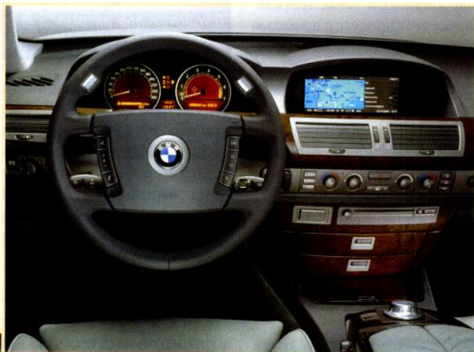
Баранка вместо клавиатуры: на руле находятся кнопки переключения передач, голосового управления, громкоговоритель мобильной связи и многое другое
