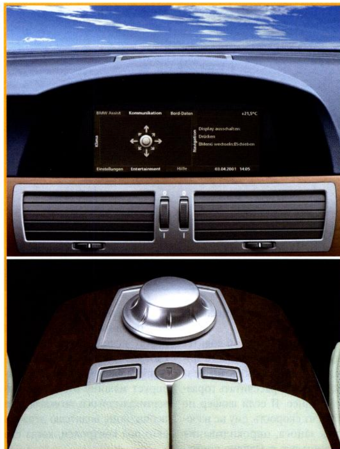
Джойстик для автомобиля: с помощью этого контроллера можно управлять сотнями функций бортового компьютера
