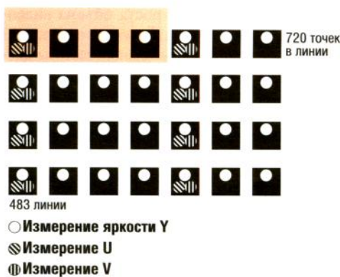
Рис. 3. Оцифровка цветного изображения по схеме 4:1:1
