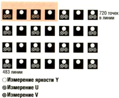
Рис. 2. Оцифровка цветного изображения по схеме 4:2:2
