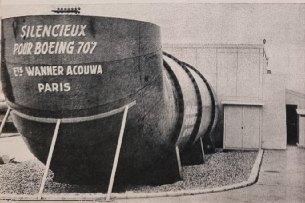
Самолет стал самым шумным детищем эры шума. Создавая двигатели огромной мощности, авиаконструкторы должны были думать и о глушителях (на верхнем снимке: глушители реактивных двигателей), сильно снижающих уровень шума без особой потери мощности двигателя. На нижнем снимке: гигантская «выхлопная труба» одного из парижских аэропортов, предназначенная для проверки работы двигателя, с помощью которой заглушается его шум, а остаточные шумы отводятся прямо в небо.
